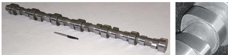
图16 采用液力胀接制造汽车发动机空心凸轮轴装配件
